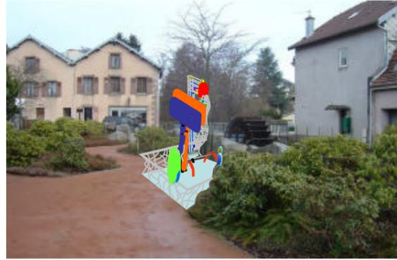
Le bassin serait alors alimenté par une noria (réservoirs montés sur une chaîne) placée en bout d'arbre de la roue côté rivière.
